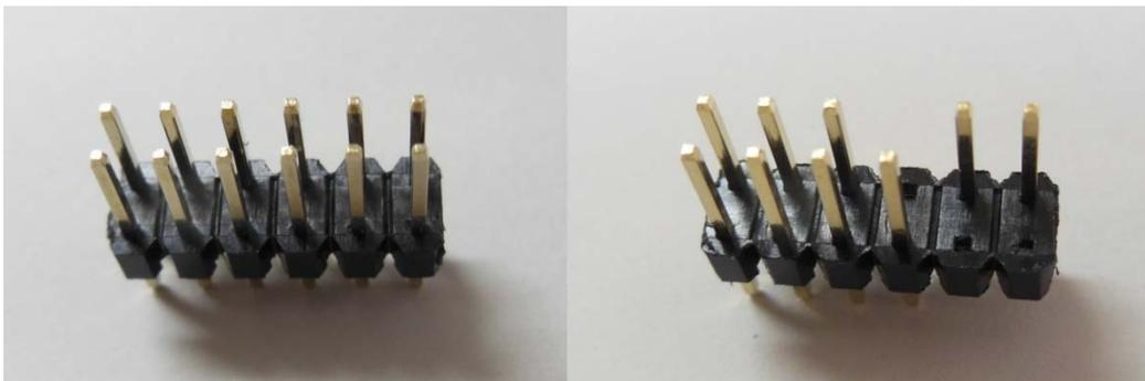
図7 2列のピンヘッダのピンを抜く場所
